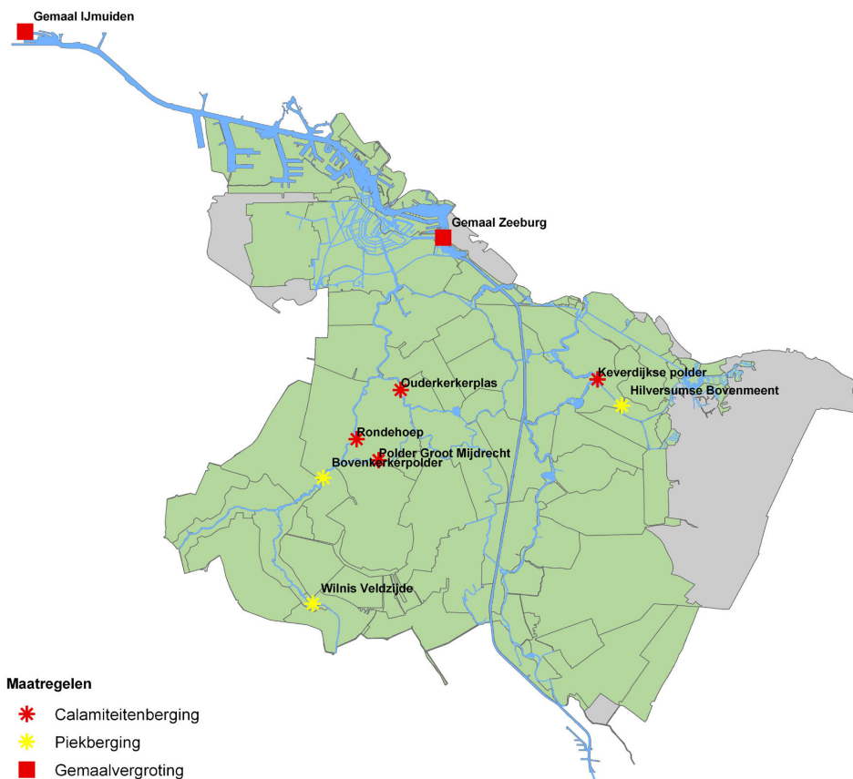
Figuur 6.1 Mogelijke maatregelen op de boezem voor het vergroten van de afvoercapaciteit
