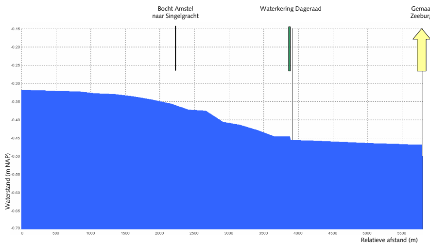
Figuur 6.2 Langsdoorsnede tracé Amstel-gemaal Zeeburg
