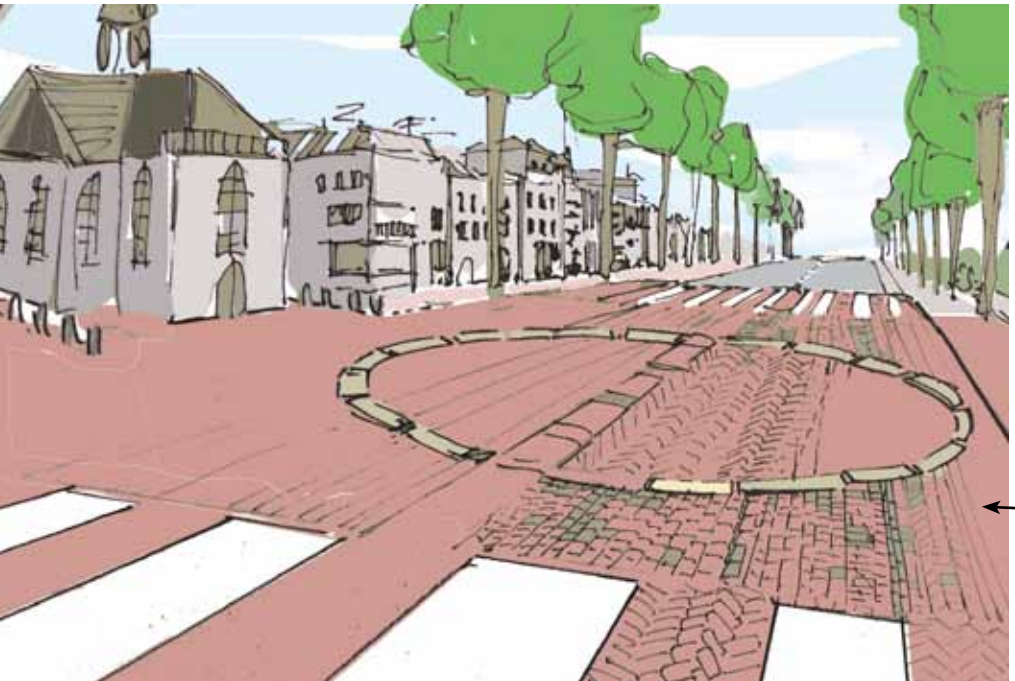
plein ligt verhoogd tussen 2 zebrapaden, rijbanen vormen flauwe bocht over het plein heen. de bestrating loopt van plint tot talud
